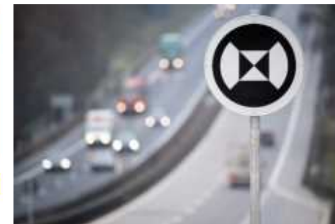
路側に絶対位置座標（GCP）を設置 (ドイツアウトバーンAルート ※約10km毎に設置)
