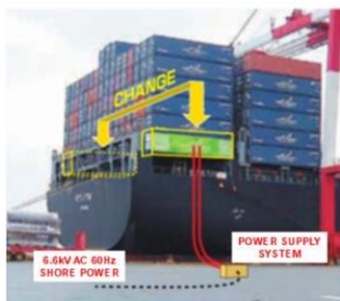
停泊中船舶への陸上電力供給
