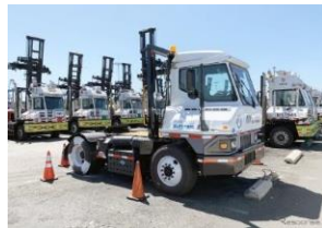
コンテナ用FCトラクター (構内用) (出典)トヨタ自動車HP
