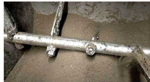
発酵中の汚泥
