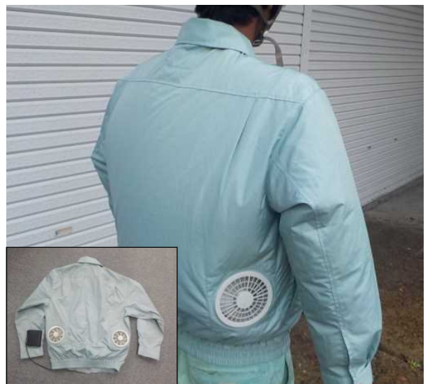
▲空調服を作業員に配布
