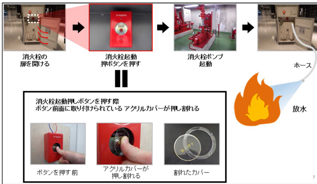
図3 火災発生時の消火栓使用手順
