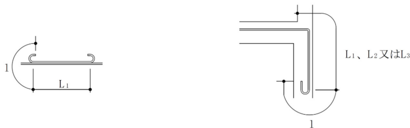
図2.4.1 フックのある場合の重ね継手及び定着の長さ
