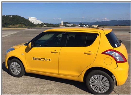
写真1 滑走路の日常点検に使用する点検車
