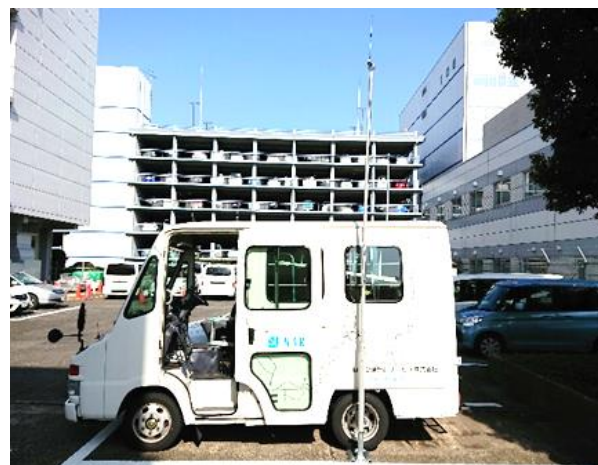
図9 空港無線(TETRA)移動基地局
