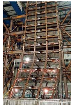
図表4 「都市の脆弱性が引き起こす激甚災害の軽減化プロジェクト」による振動台実験(H26.5文部科学省他報告書)
