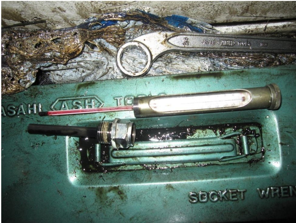
写真 1 2 主機潤滑油冷却器下で発見された温度計、ケース ス枠及び感温外筒
