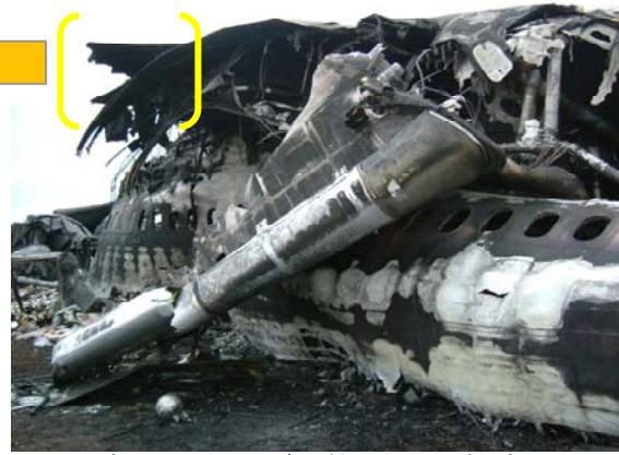
裏返しとなった事故機（左主翼破断部）
