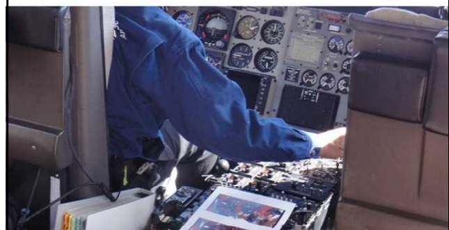
検証時(上昇時のCPレバー位置でITTトリム・スイッチ操作中)
