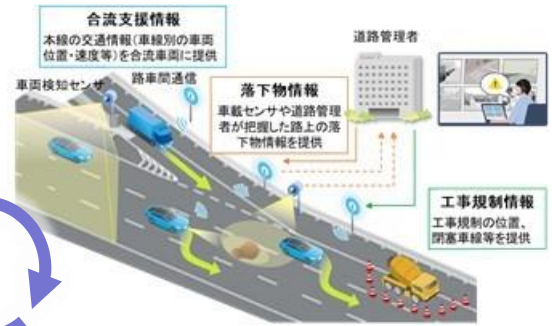
道路インフラによる支援 (路車協調システム)
