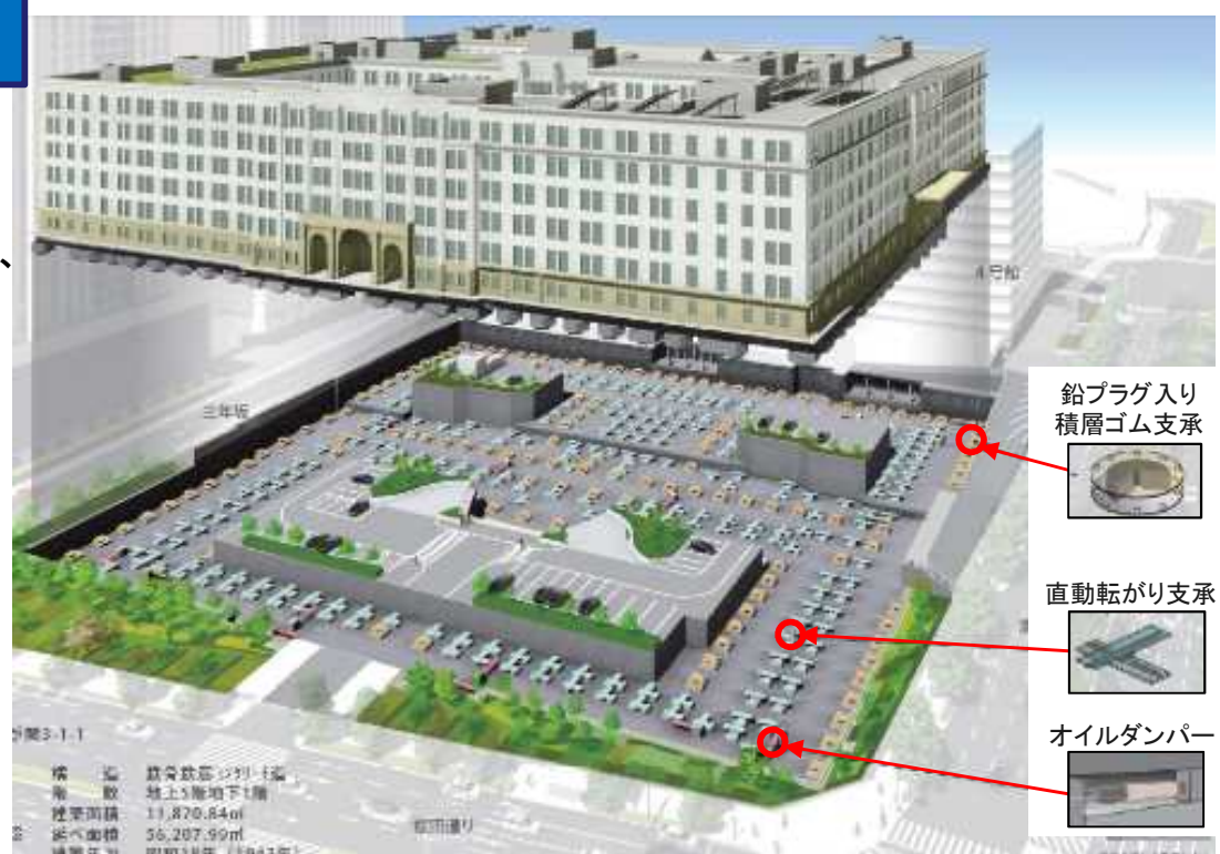
免震工法による改修イメージ
