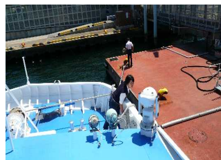
入港作業でウインチを操作する機関長、船を定位に素早く係留して、お客様が安全に下船されるには、的確なウインチ操作が必要です。船は波で大きく揺れ、風に流されて係船ロープには大きな力が掛かります。機関長の腕の見せ所です。
