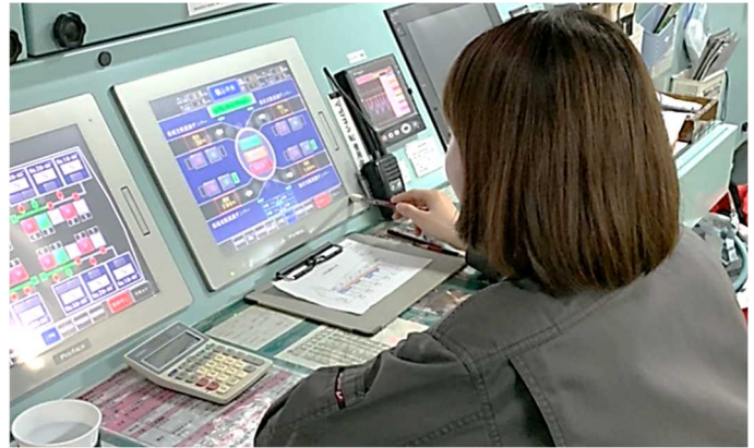
「船内荷役業務の様子」セメント輸送（船内積み荷役及び陸上揚げ荷役）はタッチパネル操作で行います。この業務は安全かつ効率の良い操作能力を求められますが、体力面で力を必要としません。
