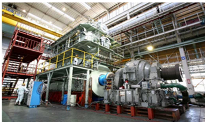
当社が製造する船舶用大型ディーゼルエンジン
