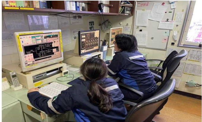
5隻のうち4隻の荷役は自動化システム導入。荷役やバラストなど、甲板上のバルブ作業の多くは荷役制御室のパソコンにより、遠隔自動制御が行われます。力仕事が減った分、オペレーションや書類仕事の割合が増え、より対等に女性の活躍の場が増えました。
