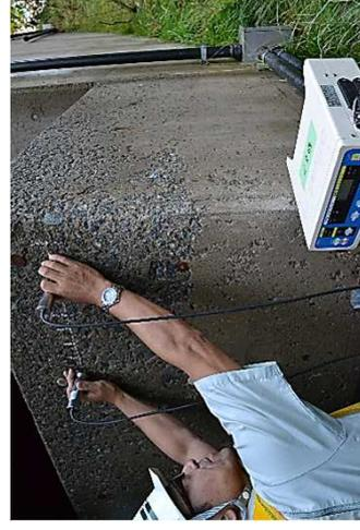
非破壊試験(表面走査法)による
