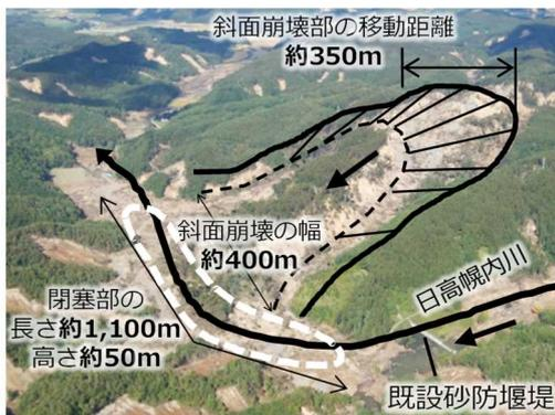
日高幌内川では、山腹崩壊の発生により大規模な河道閉塞が発生
