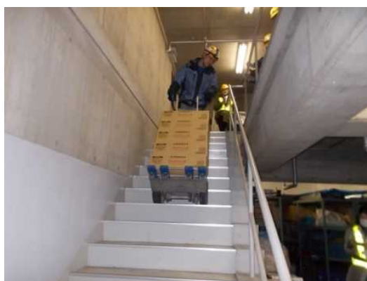
図表Ⅱ-3-2 階段運搬機を使用した荷降ろし
