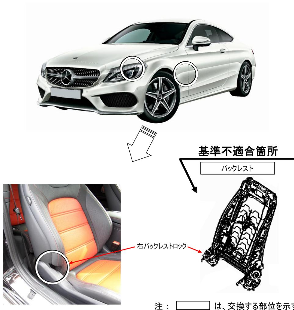
運転席及び助手席のバックレストのロック機構において、構成部品の寸法が不適切なため、ロック機構が正常に作動せず、バックレストが確実に固定されないことがある。そのため、衝突等によりバックレストに強い力が加わった際、バックレストが前方に倒れ、最悪の場合、乗員が負傷するおそれがある。
