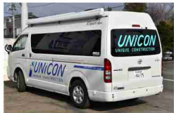
衛星通信・広域無線機・発電機能を備えたモバイルオフィス
