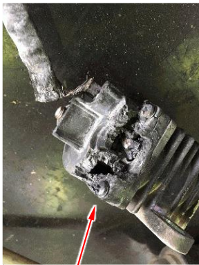
運転席右側コンソール内に取付けられているリレーが火花を伴う短絡により損傷する
