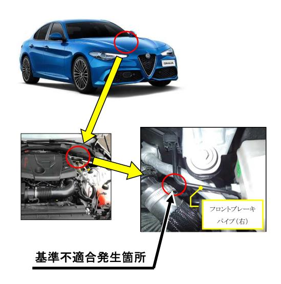
エンジンルーム内において、右フロントブレーキパイプの取り回しが不適切なため、走行振動等によりエンジン冷却 用ホースの固定バンドに干渉するものがある。そのため、当該パイプが損傷し、ブレーキフルードが漏れ、制動力が 低下して、最悪の場合、ブレーキフルードが熱源に触れると、車両火災に至るおそれがある。
