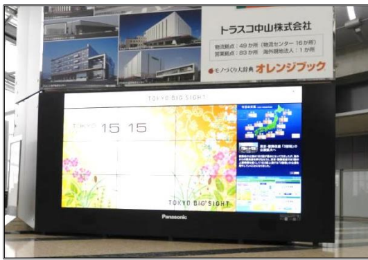
エントランスホール : 12面マルチ+LEDライトバー
