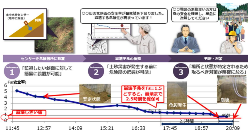
斜面崩壊危険度の経時変化事例
