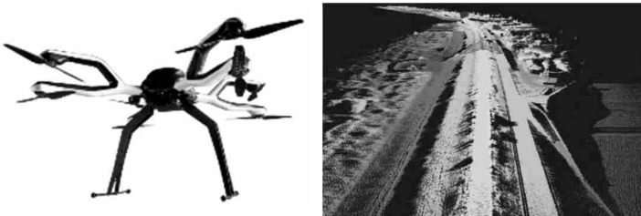
UAV（ドローン）により取得した 三次元点群データによる河川管理
