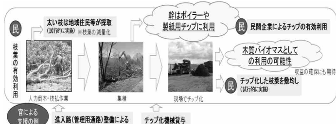
PPP事業スキームのイメージ （山形県内におけるモデル事業の例）
