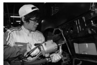
超高張力鋼板の溶接
