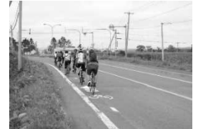
路面への通行位置明示
