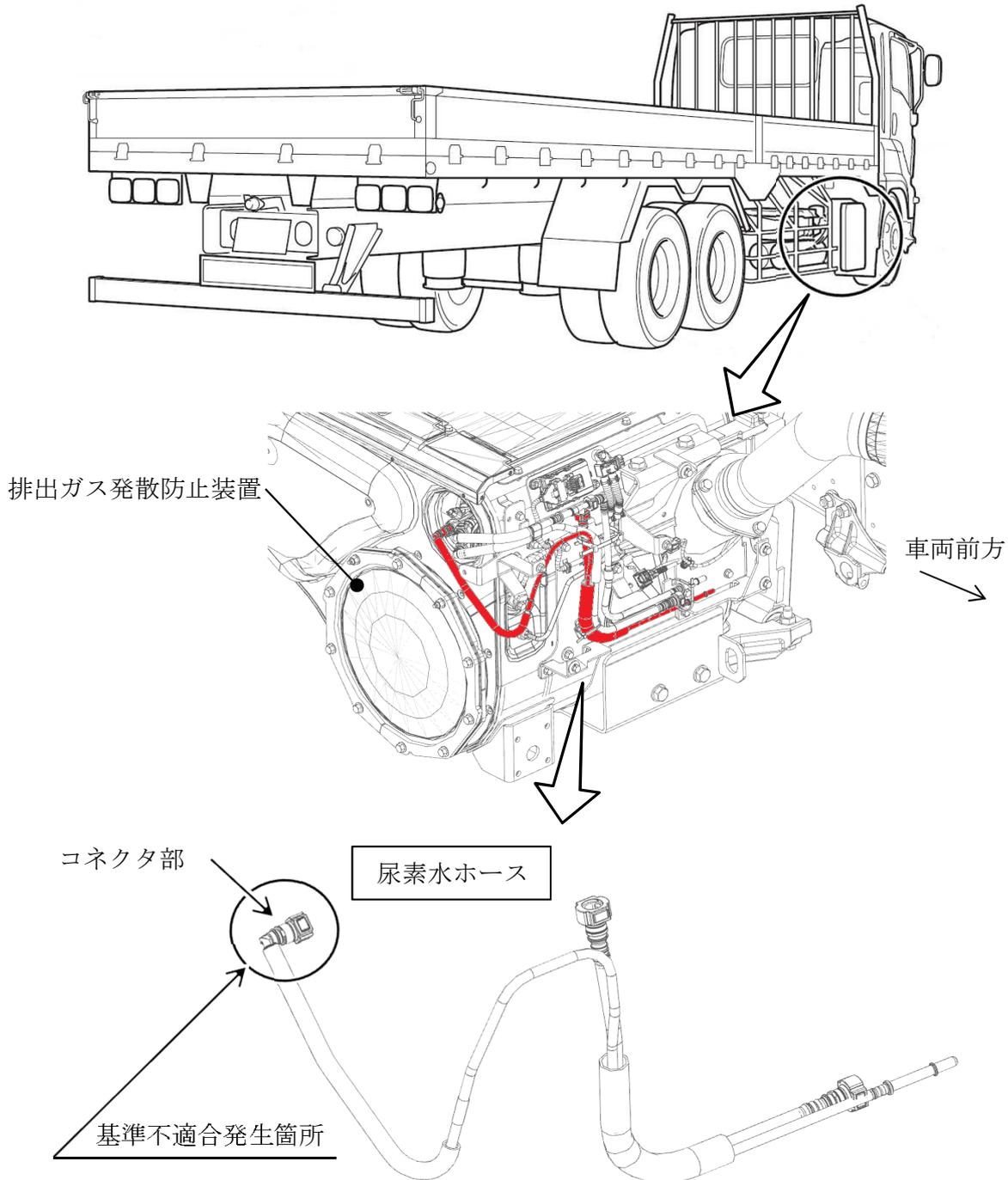
大型トラックの排出ガス発散防止装置において、尿素水ホースの耐熱性が不足しているため、DPD（粒子状物質除去装置）の熱により当該ホースのコネクタ部が溶損するものがある。そのため、そのままの状態で使用を続けると、尿素水が漏れ、排出ガスが基準値を満足しないおそれがある。
