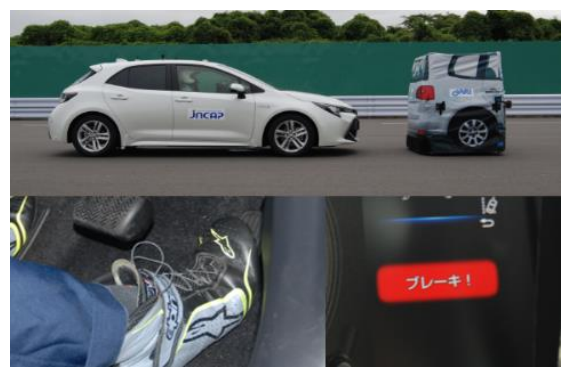
【ペダル踏み間違い時加速抑制装置試験の様子】
