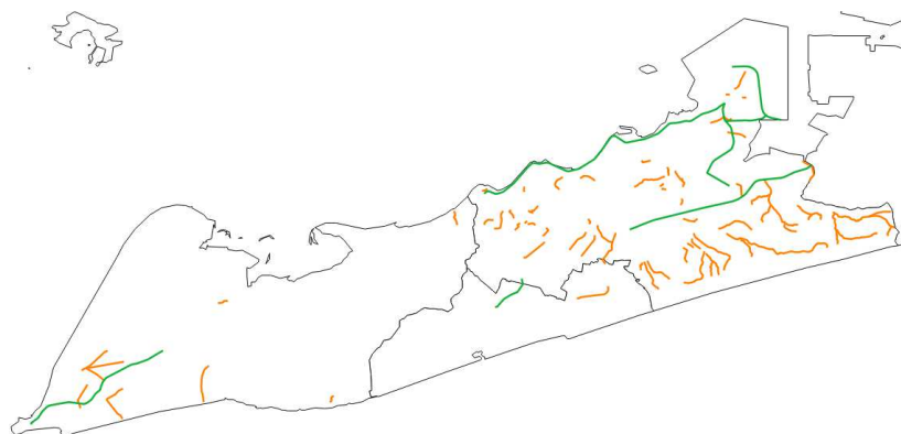
図 4 除草対象の道路・河川分布（緑：道路、オレンジ：河川）
