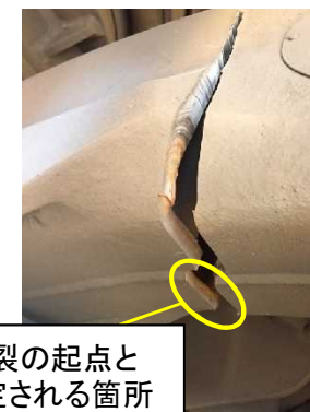
側ばり内部の補強板の状況
