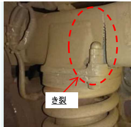
台車枠の一部にき裂
