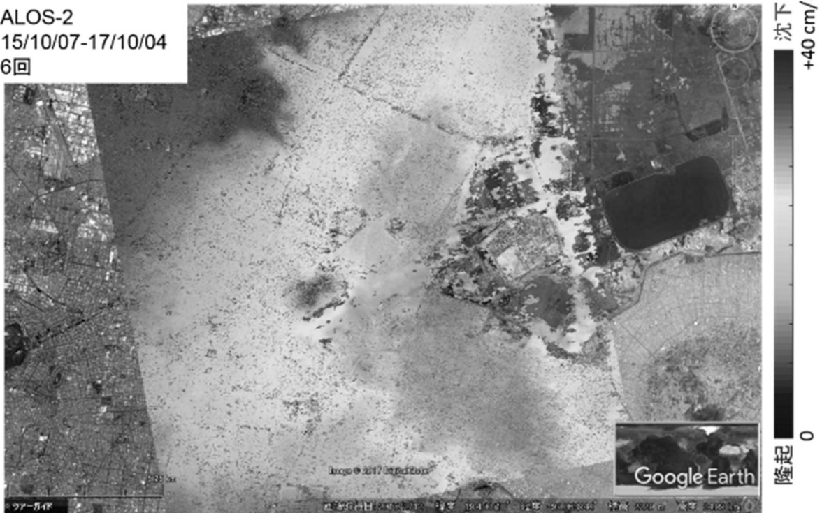
図 3 メキシコシティ周辺の地盤沈下の解析例。メキシコシティ国際空港は画像中心に位置している
