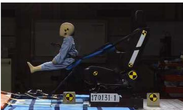
保安基準適合マークが表示されていないチャイルドシートの衝突実験を行ったところ、固定金具は壊れ、ダミー人形は前方に放りだされていきました。また、ダミー人形が放出されなくても腹部などを強く圧迫して、重篤な傷害を及ぼすおそれがあります。
