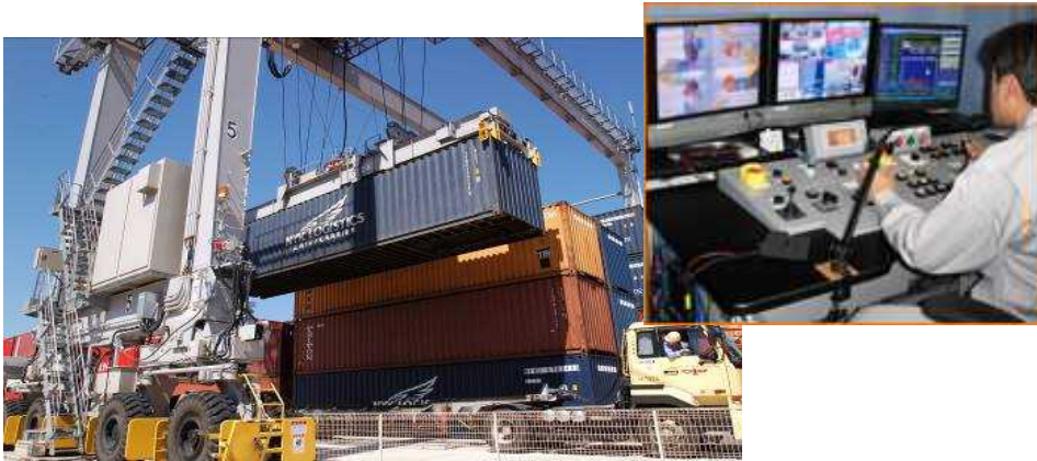
①遠隔自働RTG(ラバータイヤ式ガントリークレーン)
