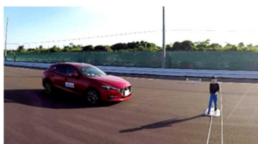
（対歩行者自動ブレーキ試験の様子）
