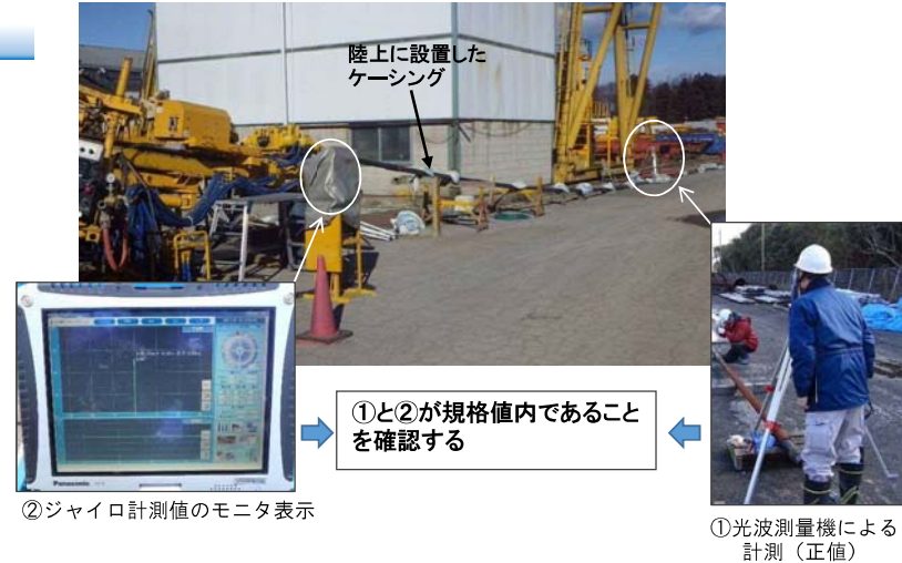
陸上における位置検出システムのキャリブレーション状況の例
