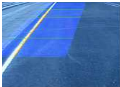
カメラ画像 白線左側エッジと車両側面の離隔距離を検出
