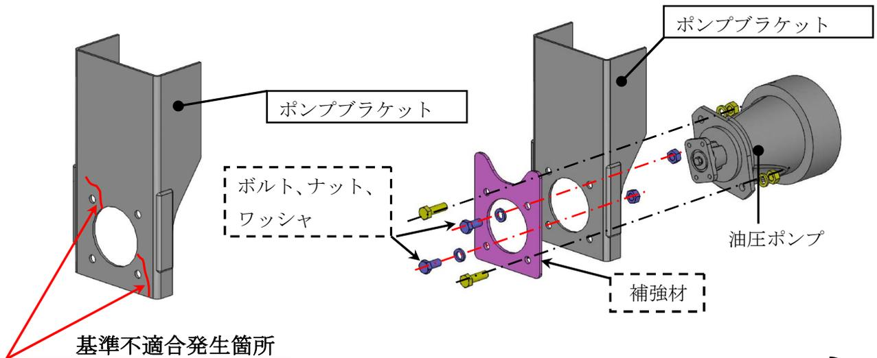
塵芥車において、作業用油圧ポンプの取付ブラケットの強度が不足しているため、走行時等による振動で亀裂が生じるものがある。そのため、そのままの状態で使用を続けると、亀裂が進展し、最悪の場合、当該取付ブラケットが破断し、油圧ポンプが脱落するおそれがある。
