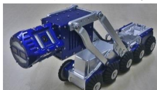
点検・調査が困難な下水管の変状を無人点検ロボットによって自動検出
