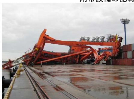
コンテナクレーンの風による逸走事故
