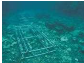
着床具の設置
