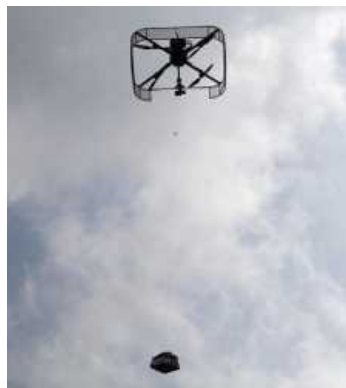
土砂サンプリング装置を吊り下げて飛行するマルチロータ機。
