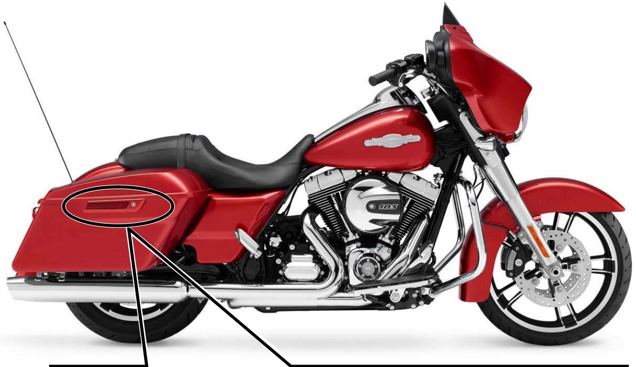
不具合箇所 サドルバッグ固定具 (レセプタクル)
