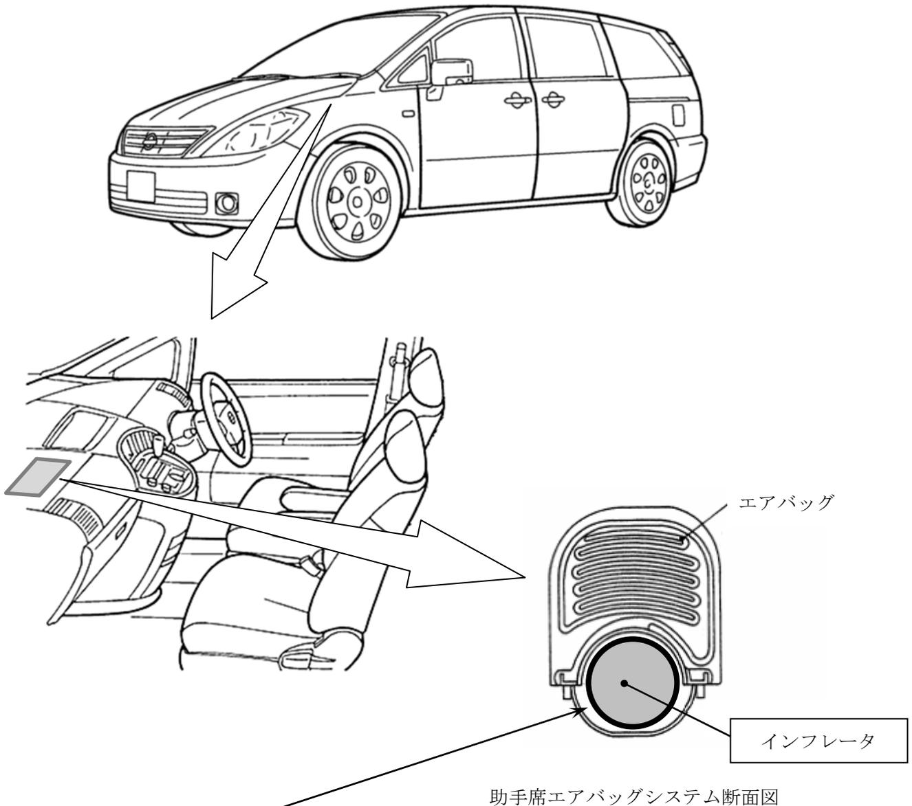
助手席エアバッグシステム断面図
