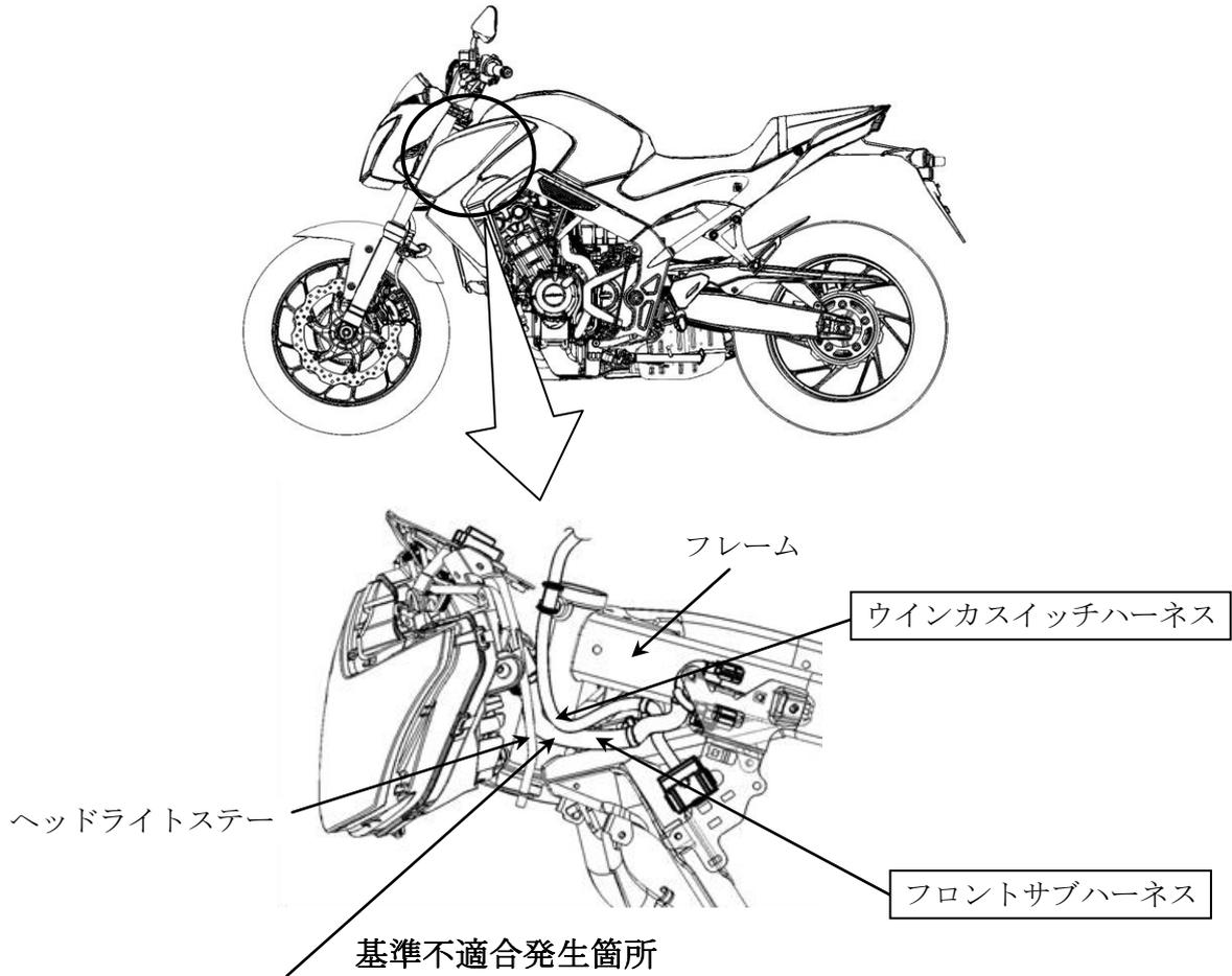
フロントサブハーネスとウインカスイッチハーネスの固定位置が不適切なため、ハンドルを左転舵した際にヘッドライトステーとフレーム間に当該ハーネスが挟まり、屈曲することがある。そのため、そのままの状態で使用を続けると、屈曲の繰り返しにより断線し、前照灯、方向指示器、速度計、警音器の作動不良や、最悪の場合、エンストして再始動できなくなるおそれがある。
