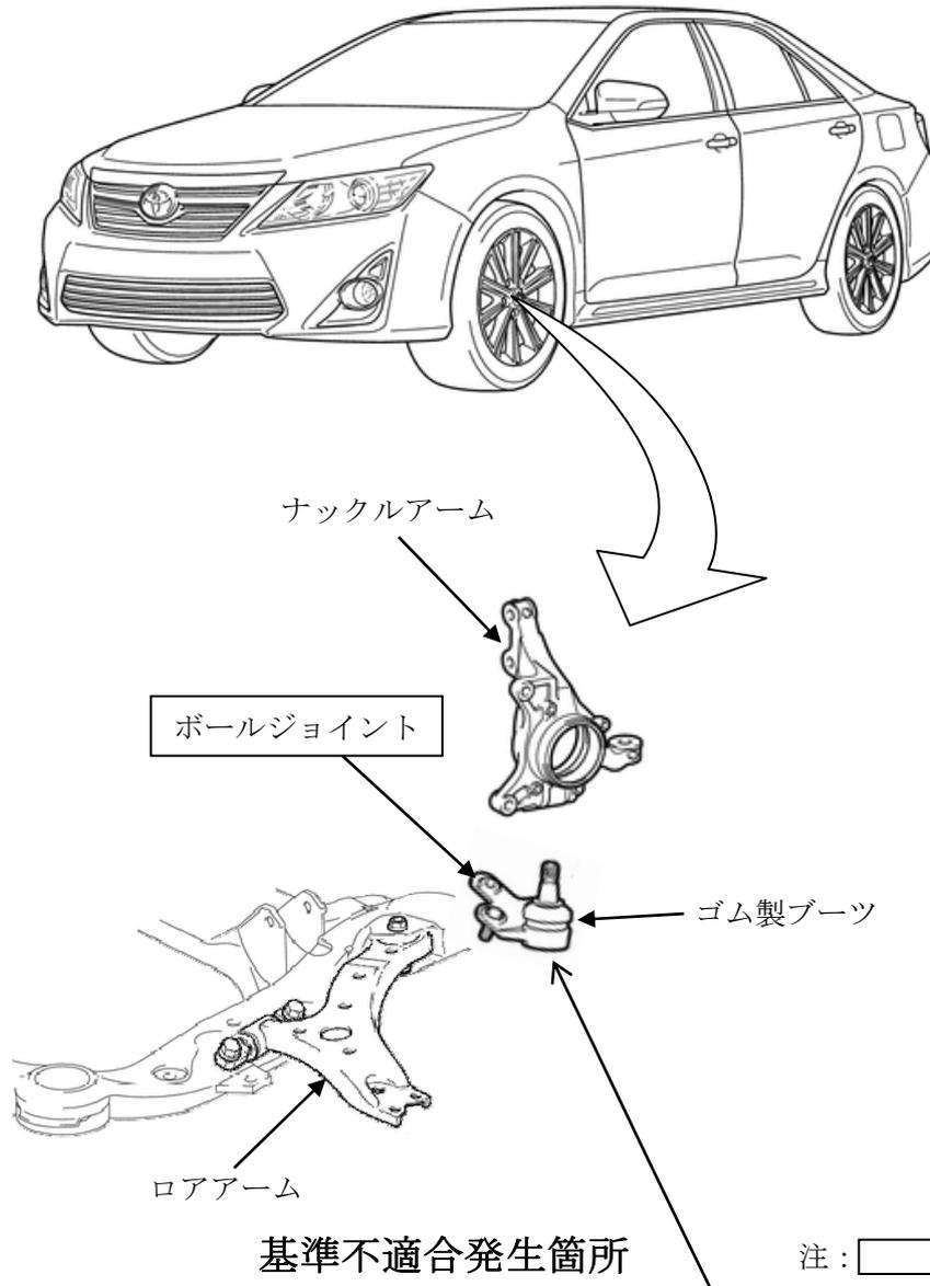
前輪緩衝装置のロアアームとナックルアームを連結しているボールジョイントにおいて、ナックルアームとボールジョイントを締結した後の部品搬送工程の管理が不適切なため、搬送設備がボールジョイントのゴム製ブーツ部と干渉して、ブーツが損傷することがある。そのため、ブーツ損傷部からグリースが漏れて、ボールジョイントが早期に摩耗し、最悪の場合、ボールジョイントがナックルアームから外れ、走行不能になるおそれがある。
