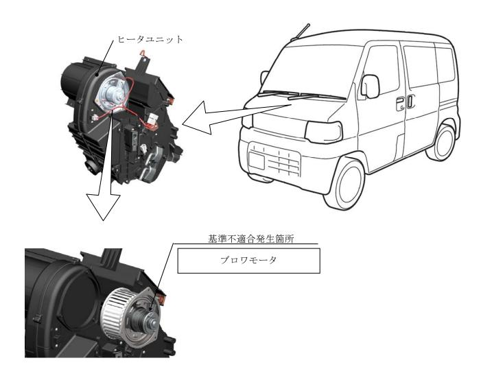
ブロワモータのブラシの材質が不適切なため、最大風量での長時間使用を繰り返すと、ブラシが早期に 摩耗する場合がある。そのため、ブロワモータの回転が遅くなり、そのまま使用を続けると作動が停止 し、前面ガラスに曇りが生じた場合に安全な視野を確保できなくなるおそれがある。
