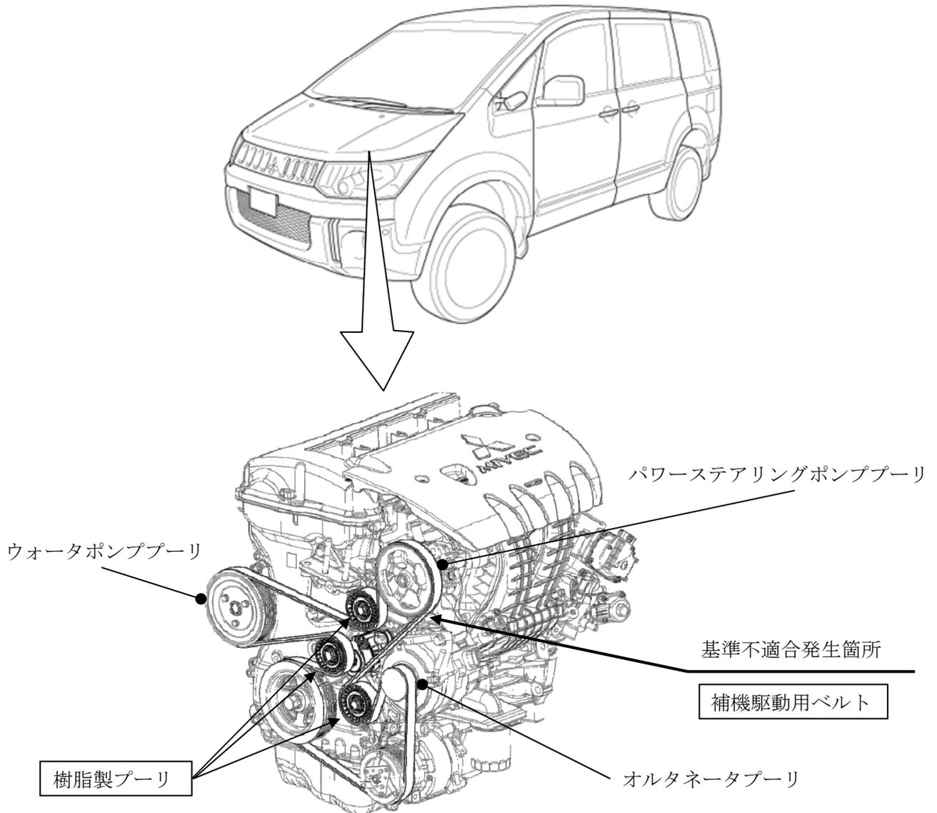
エンジンの補機駆動用ベルトの材質が不適切なため、樹脂製プーリが傾斜状に摩耗するものがある。そのため、そのまま使用を続けると当該ベルトが損傷して外れ、警告灯が点灯するとともに、バッテリー上がりまたはオーバーヒートに至るおそれがある。また、油圧パワーステアリング車においては、操舵力が増大するおそれがある。
