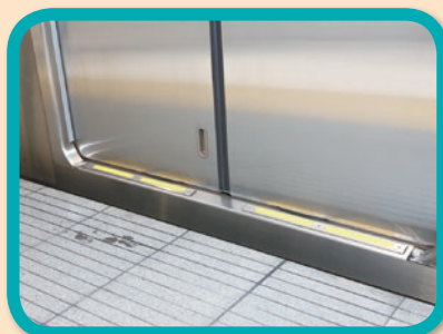
車両床面の高さを低くし、ホームとの段差を極力少なくしています
