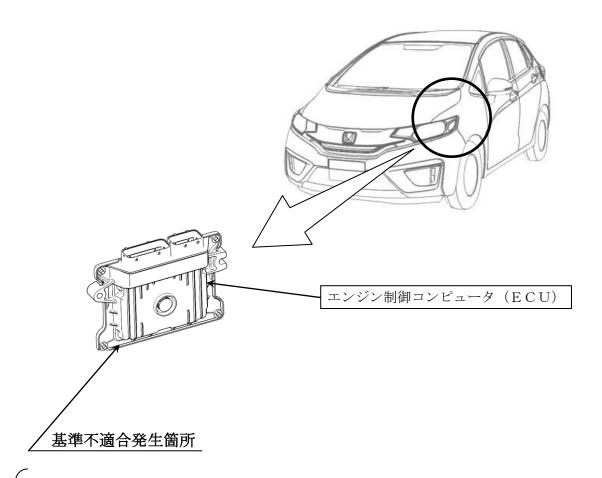
エンジン制御コンピュータ (ECU) のプログラムが不適切なため、
